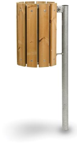
Cestino in legno per parchi pubblici. Realizzato con paletto di sostegno in tubo tondo di acciaio zincato a caldo Ø 50 mm e altezza cm 120 da interrare. Cestino di forma cilindrica in lamiera di acciaio rivestito con fasce in pino nordico impregnato in autoclave con sali atossici. Interamente zincato. Sganciamento del cestino con chiave a brugola fornita in dotazione.
