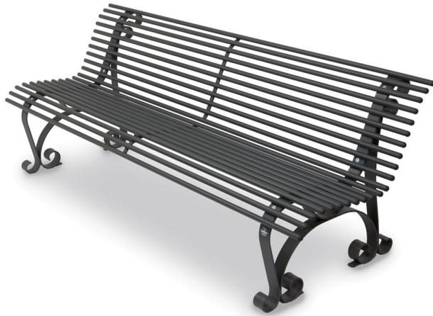
Struttura con due supporti di forma anatomica realizzati in ferro piatto sagomato. Lunghezza cm 200. Scocca composta da N°22 profili in acciaio di sezione tonda mm Ø20 dotati di tappi in plastica alle due estremità. Fissaggio ai supporti mediante bulloneria in acciaio zincata. Predisposta per l'ancoraggio nel terreno. La panca viene fornita al Cliente in kit di montaggio. Colorazioni: Grigio micaceo. Interamente zincata e verniciatura a forno a 180°. Peso Kg.47. Altezza sedile cm 41.
