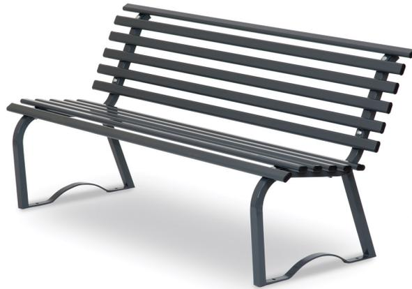
Struttura con n° 2 supporti in tubo quadro di acciaio sezione mm 30x30, di forma anatomica. Lunghezza cm 150. Scocca composta da dodici profili in acciaio di sezione ovale mm 40 x 20 dotati di tappi in plastica alle due estremità. Fissaggio ai supporti mediante bulloneria in acciaio zincata. Predisposta per l'ancoraggio nel terreno. La panca viene fornita al Cliente in kit di montaggio. Interamente verniciata a forno a 180°.
